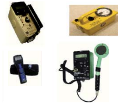
Imagen 4.32 Medidores o detectores portátiles de radiación. Equipos de medición de lectura directa y de tamaño pequeño, utilizados para efectuar levantamientos radiométricos
