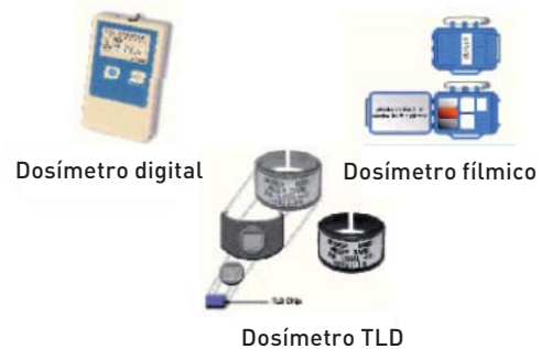
Imagen 4.33 Dosímetros. Medidores de radiación utilizados para medir la dosis recibida por el personal ocupacionalmente expuesto
