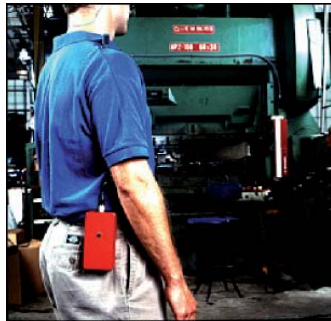
Imagen 4.1. Trabajador utilizando un dosímetro de ruido
